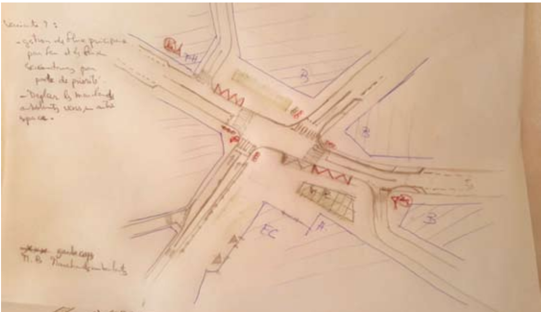
Variante carrefour à feux avec reprise importante de l'aménagement et limitation de certains mouvements
