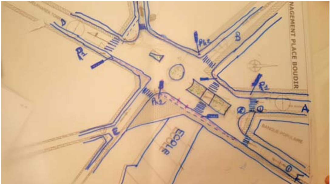
Variante carrefour feux sous la forme d'une place tournante et mise à sens unique
